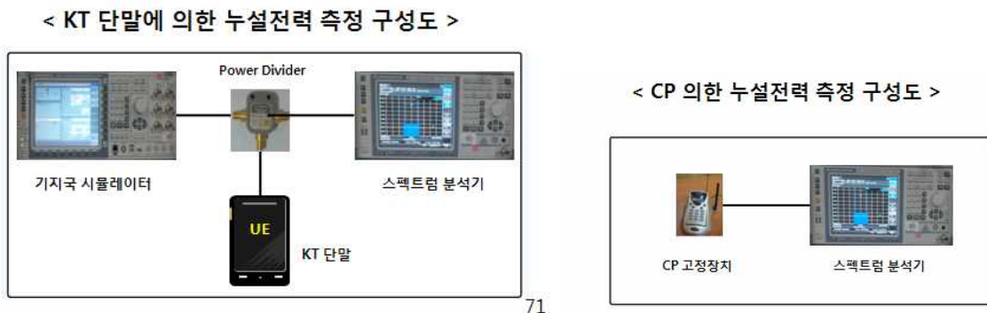
[그림 4-11] 누설전력 측정 구성도
