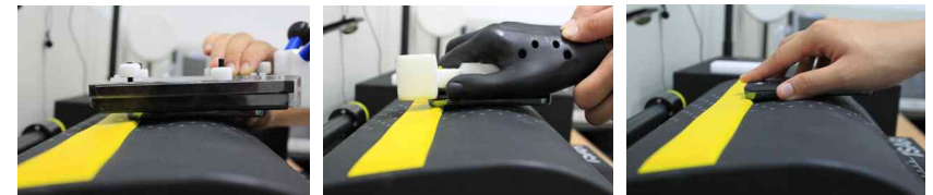
그림 4-9 삼성 제안 손 팬텀, CTIA 손 팬텀, 실제 손과의 SAR 비교 측정 모습
