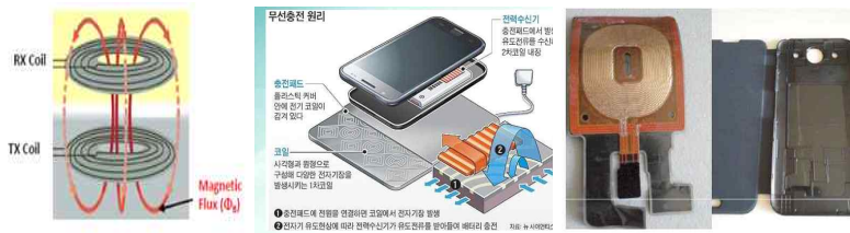
그림 2-11 휴대전화 무선충전기 원리 및 내부 구조
