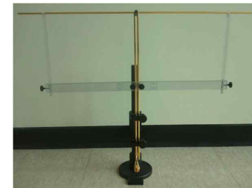
그림 3-3 제작된 150 MHz 대역의 다이폴 안테나
