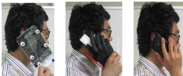
그림 4-11 삼성 제안 손 팬텀, CTIA 손 팬텀, 실제 손과의 안테나의 반사손실 비교 측정 모습
