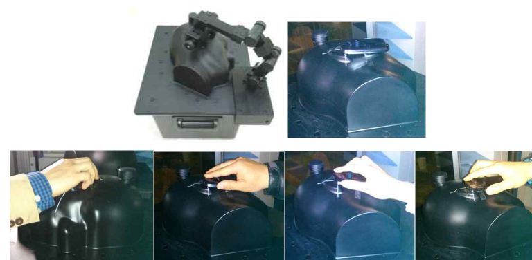
그림 4-13 손 팬텀과 10명의 실제 손과의 SAR 비교 측정 모습
