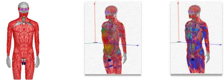
(a) 성인 남자 인체 모델 (b) 유도전류밀도 계산 (c) 국부 SAR 계산
