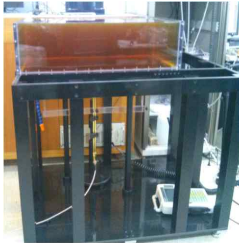
그림 3-5 제작된 150 MHz 대역 평면형 모의인체(size 4)
