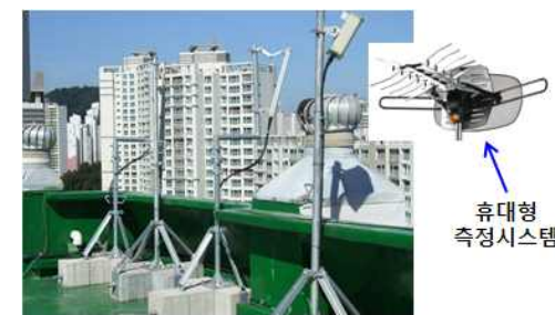
[그림 2-20] 건물 변두리에 설치된 안테나 형태
