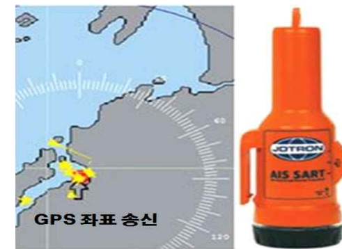
[그림 3-8] AIS-SART 개념도 및 실제 이미지
