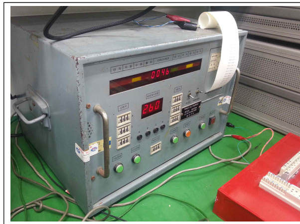
[그림 2-3] 보호기의 직류 방전특성 측정의 예
