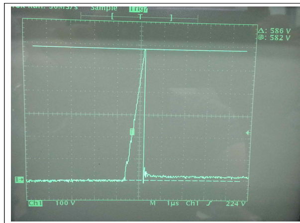
[그림 2-5] 충격파 방전특성( 1,000\text{V}/\mu\text{s} 상승전압) 측정의 예
