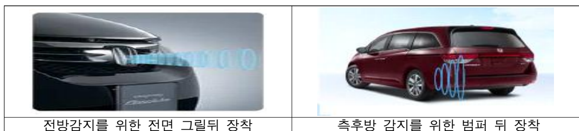
[그림 7-12] 차량레이더 장착 위치
