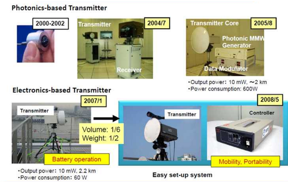
[그림 6-7] 일본 NTT의 120GHz 대역 무선통신시스템 개발
