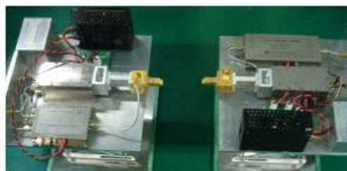
[그림 6-9] 246GHz 대역 무선영상전송시스템(ETRI)
