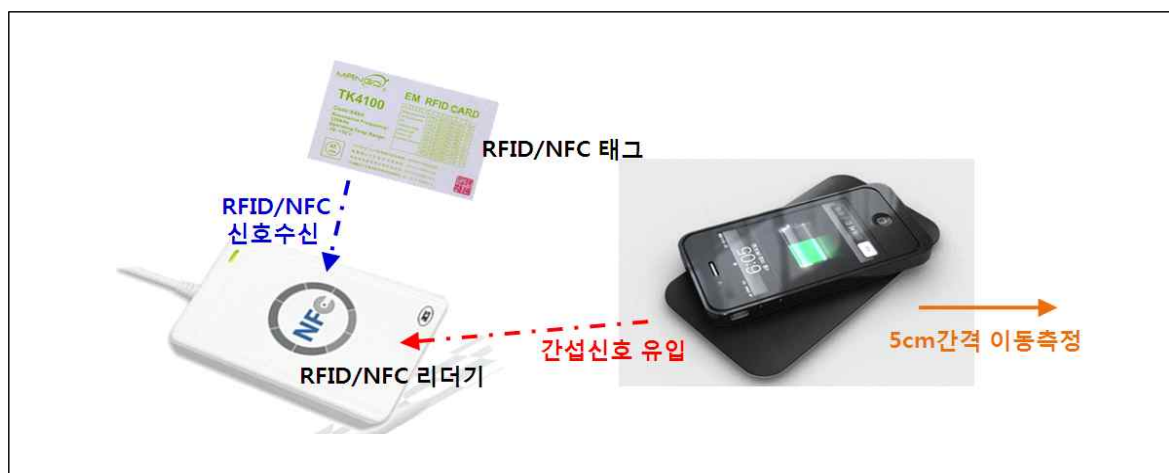
[그림 8-16] 13.56MHz 무선설비와 간섭실험 측정 구성
