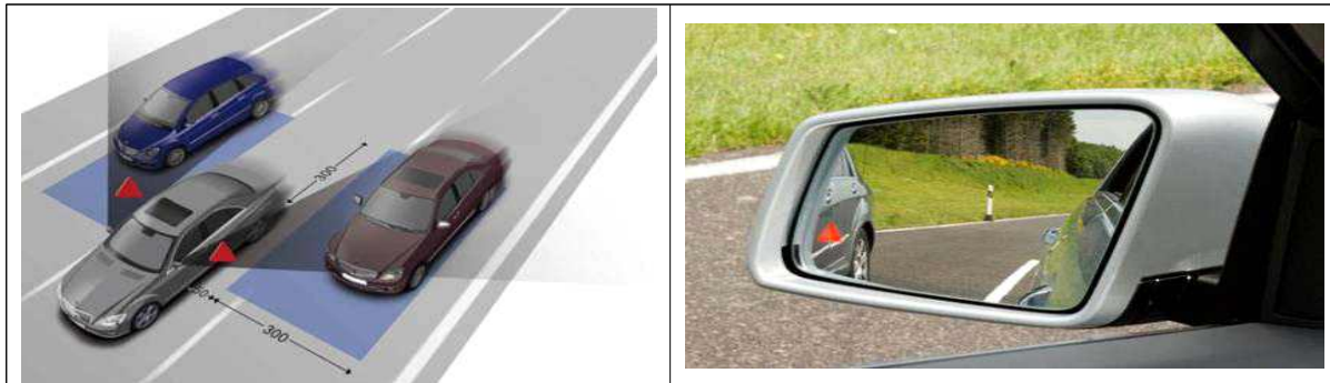
DAIMLER 社 (Mercedes-Benz) 사각지대탐지(BSD) 기능
