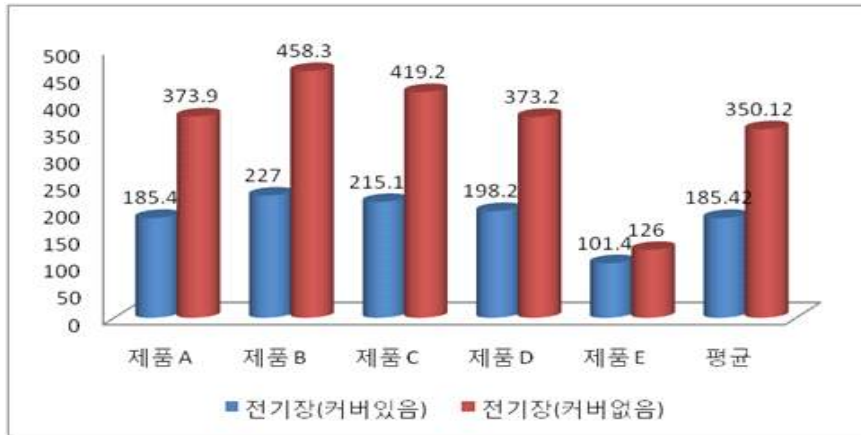
그림 3-18. 헤어드라이어 커버 유무에 따른 전기장 강도 측정 결과
