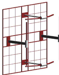
그림 5-4. 슬로베니아의 FM 방송국에 설치된 4-다이폴 안테나 구성
