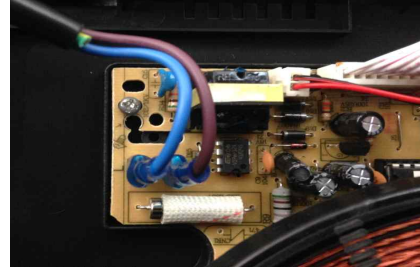
a. Con사 인덕션 쿠키 내부 사진 b. 전원 연결 부위 사진(확대)
