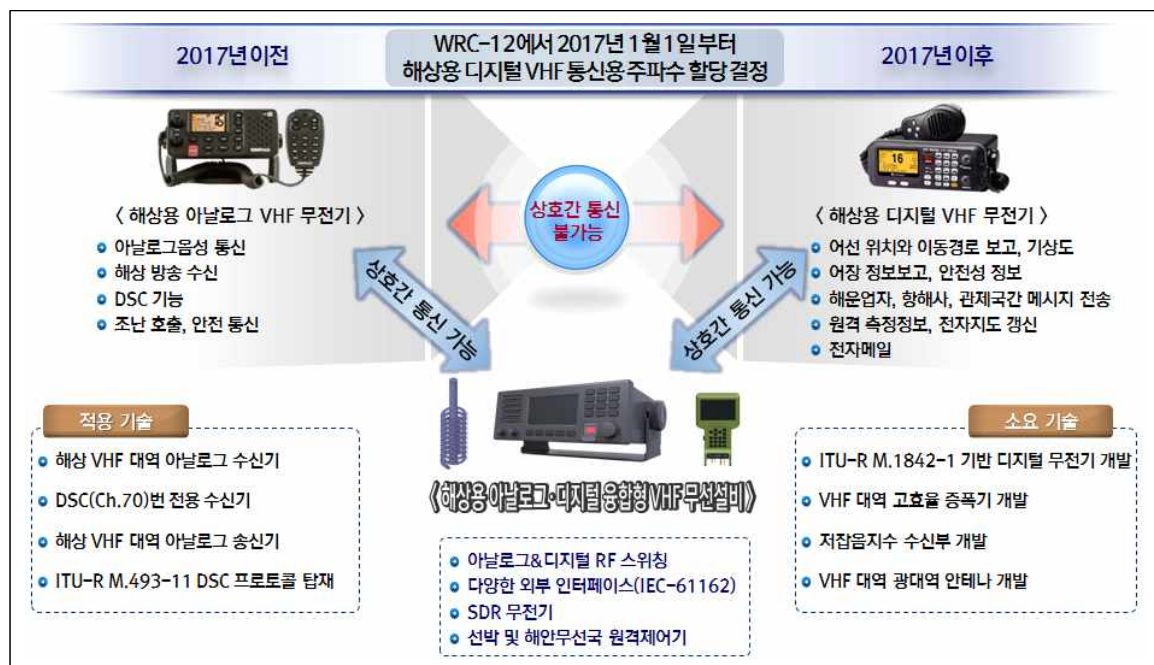
[그림 4-25] 해상용 융합형 VHF 무선설비 개요도
