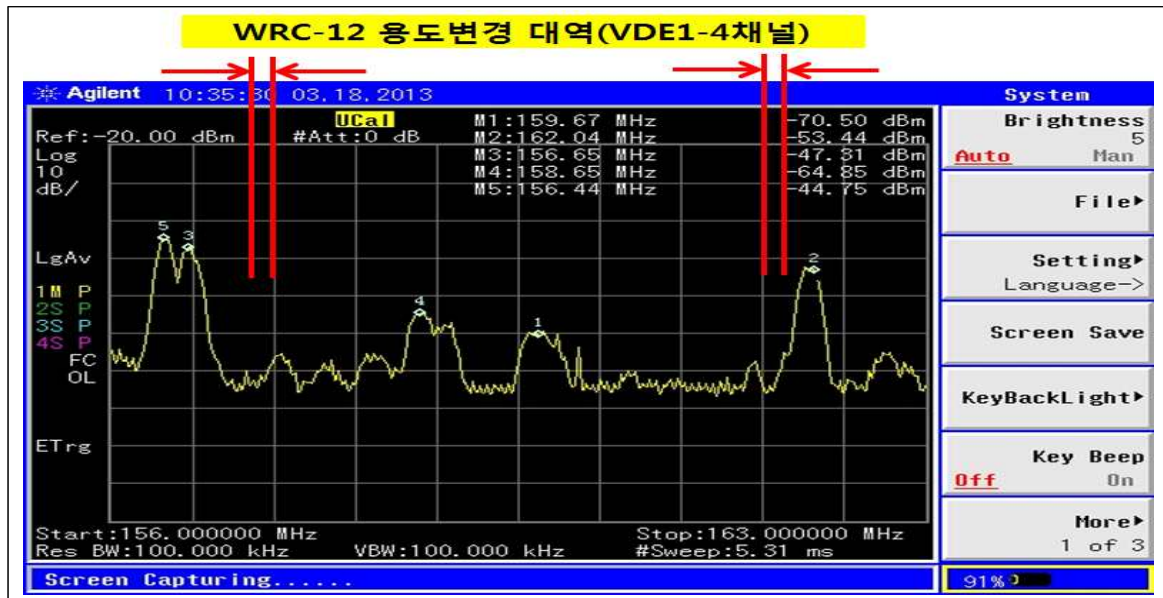
[그림 3-17] 156~163MHz 대역의 주파수 환경 측정결과(목포)
