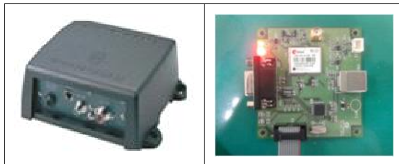
[그림 2-20] AIS Class B 장치 구성
