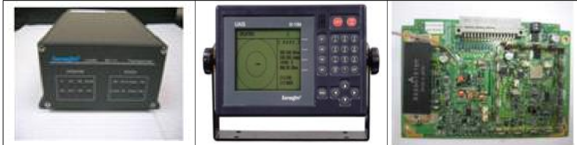
[그림 2-19] AIS Class A 장치 구성
