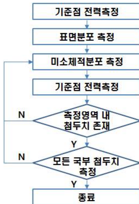
그림 3-10. Body SAR 측정절차
