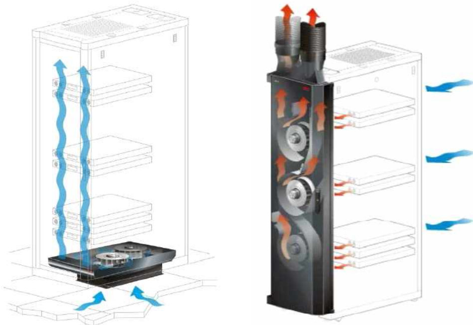
(a) 랙 장착형 덕트식 공기 공급 장치 (b) 랙 장착형 덕트식 공기 순환 장치
