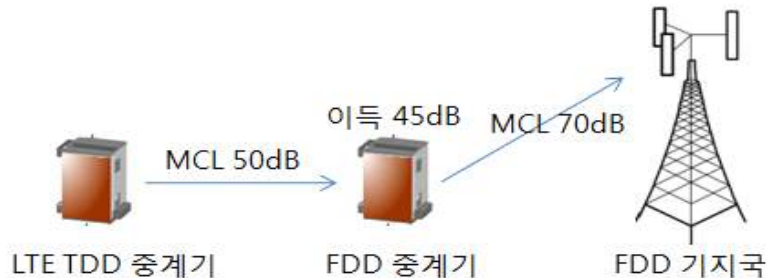
[그림 2-7] LTE TDD 중계기가 LTE FDD 상향 중계기에 주는 간섭
