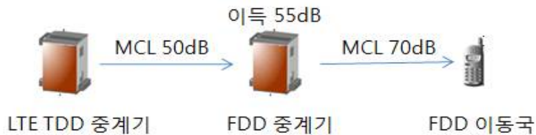
[그림 2-8] LTE TDD 중계기가 LTE FDD 하향 중계기에 주는 간섭
