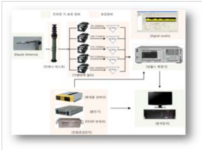
(그림 4-11) 간이 이동식 전파 잡음 측정시스템 구성도
