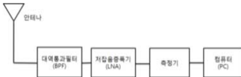
(그림 4-17) 임펄스성 잡음 측정시스템 구성도
