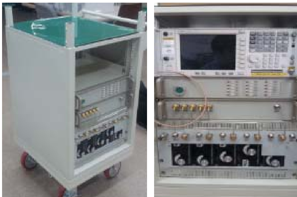
(그림 4-7) 제작된 간이 이동식 측정시스템 부 외형 사진
