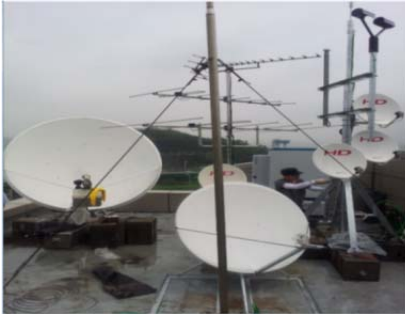
(그림 3-5) 위성방송용 수신용 측정시스템 구축 사진
