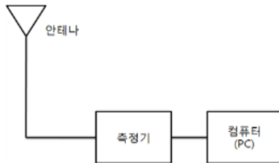
(그림 4-16) 임펄스성 잡음 측정대상 주파수 선정을 위한 측정시스템 구성도
