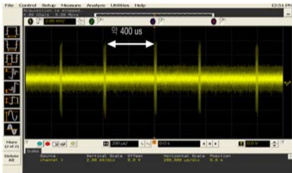
(그림 4-20) 오실로스코프로 측정한 UWB 소스 결과
