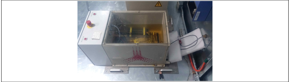
그림 2-11 입력케이블 종류 비교시험 시험사진1 (일반케이블)
