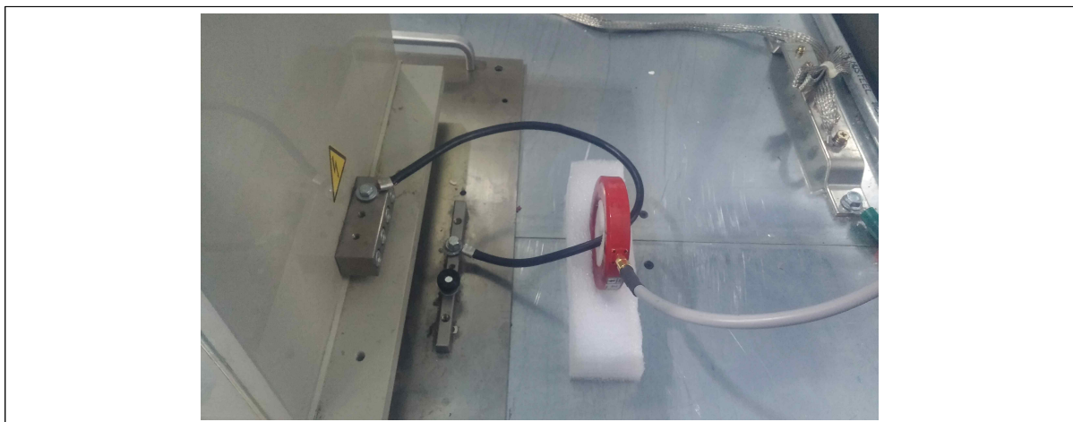
그림 2-39 케이블 굵기 변화시험 (16SQ, 40cm)
