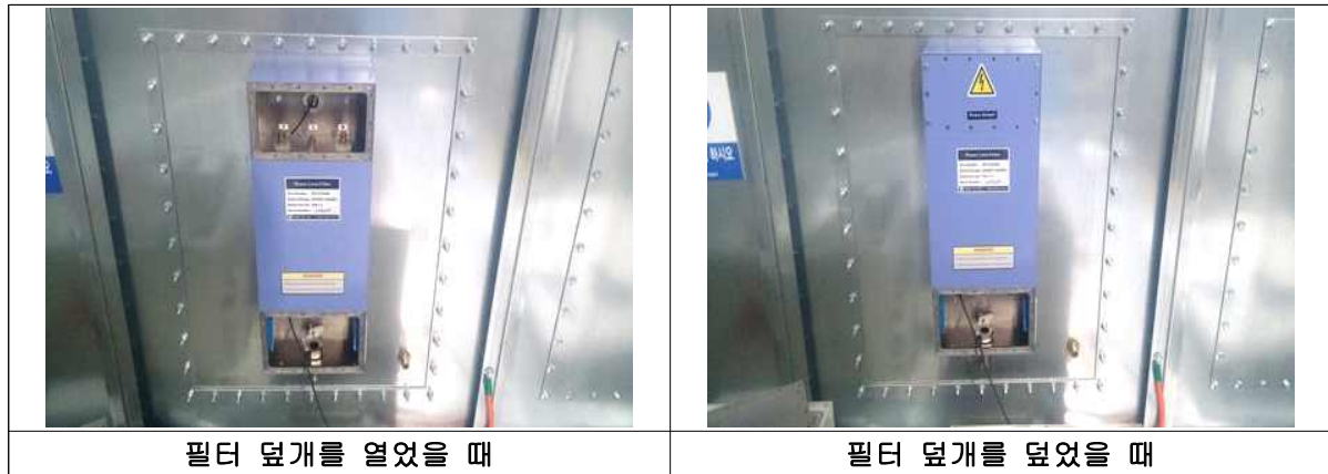
그림 2-50 필터 덮개유무 비교시험 사진
