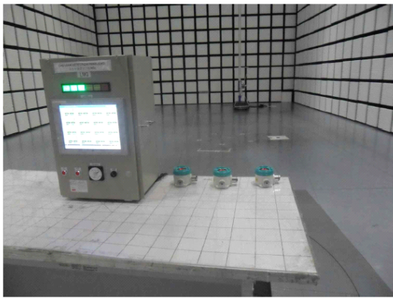
[그림 15] 가스누설 경보기(A모델) 전도성 방해와 방사성 방해 측정결과
