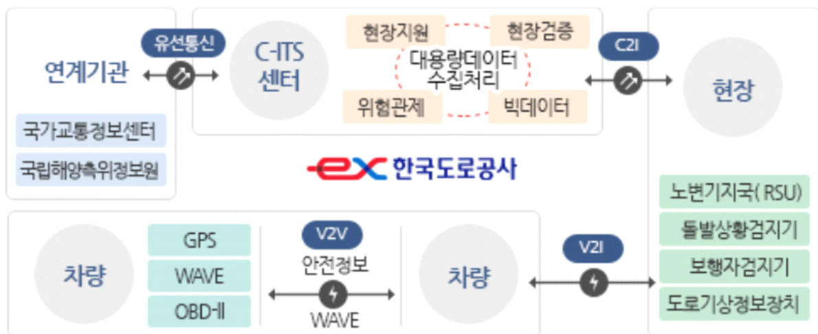
그림 37. C-ITS 시스템 구성도
