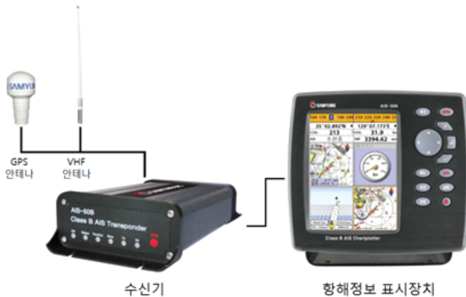
그림 2. 선박에 장착되는 AIS 구성도
