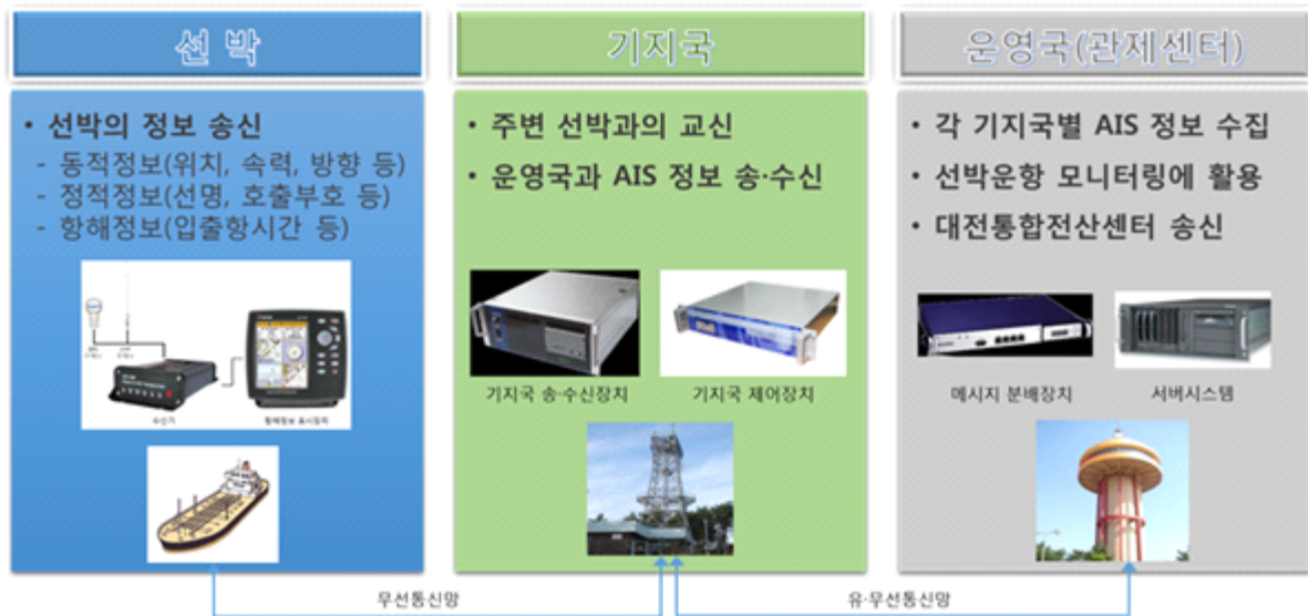
그림 3. 선박자동식별시스템 구성 및 운영
