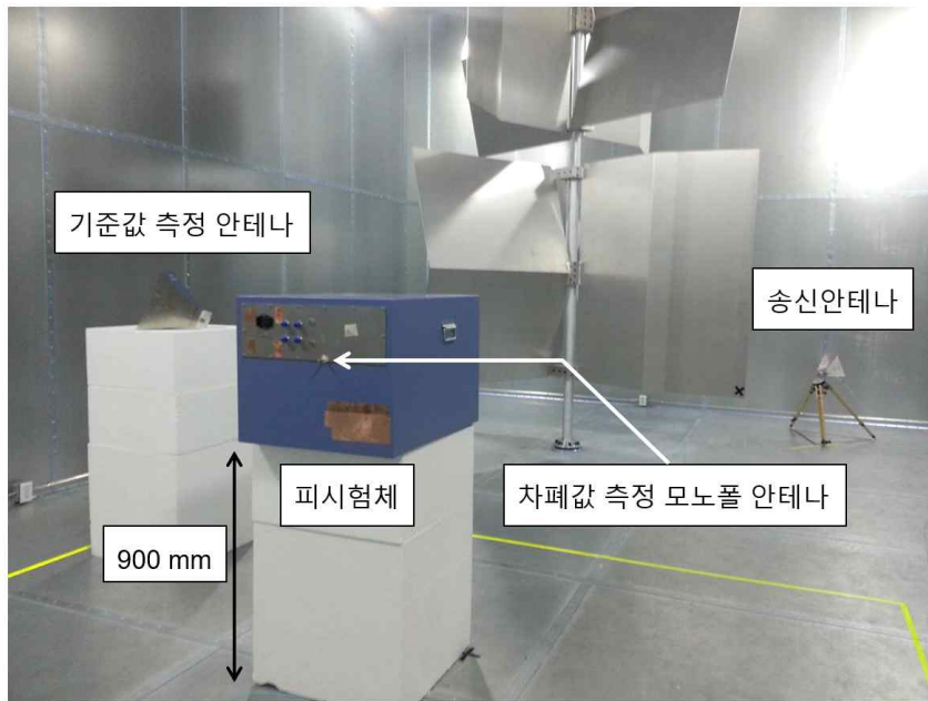
그림 3-10. 국립전파연구원 보유 전자파 잔향실 이용 차폐성능 시험구성 1
