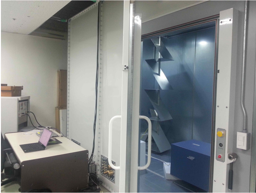
그림 3-6. 소형합체 차폐효과 전자파 잔향실 구성
