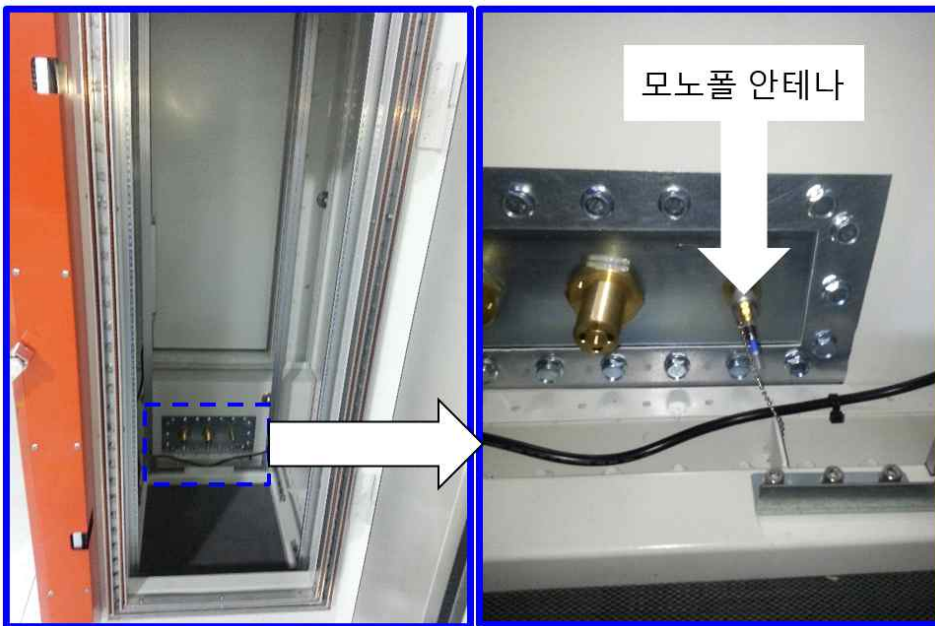
그림 3-29. 피시험체 내부 모노폴 안테나 설치 사진
