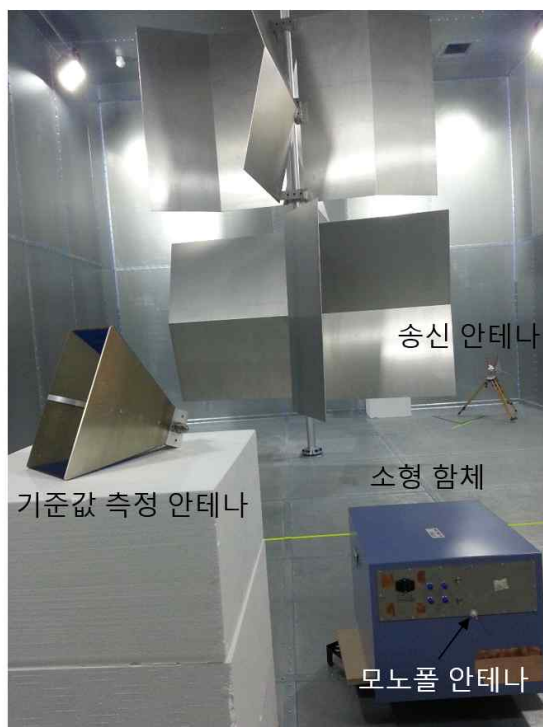
그림 3-13. 높이 변화 (h=100mm) 영향 분석을 위한 시험 구성 1
