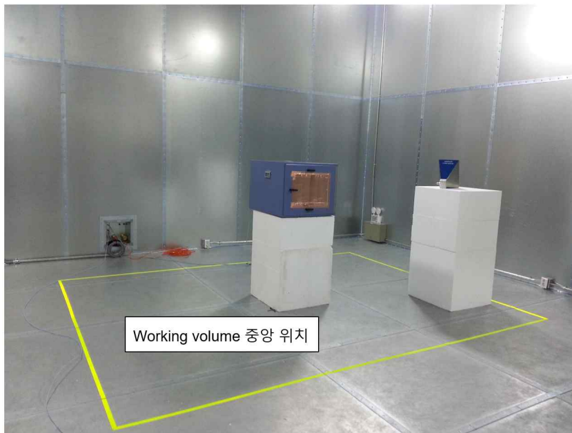
그림 3-11 국립전파연구원 보유 전자파 잔향실 이용 차폐성능 시험구성 2
