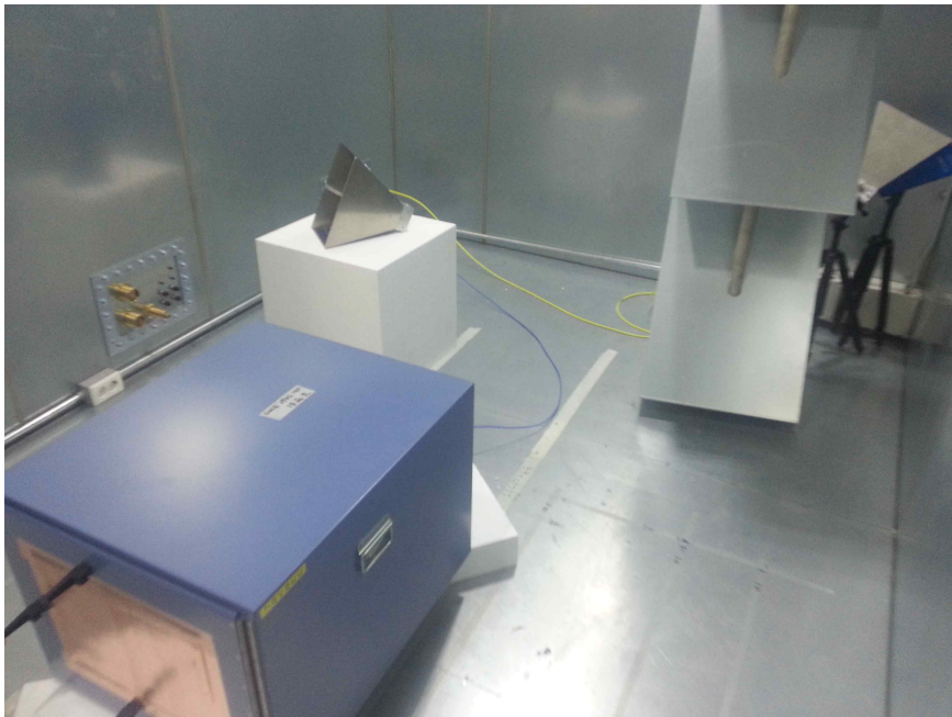
그림 3-7. 전자파 잔향실 시험 구성 내부
