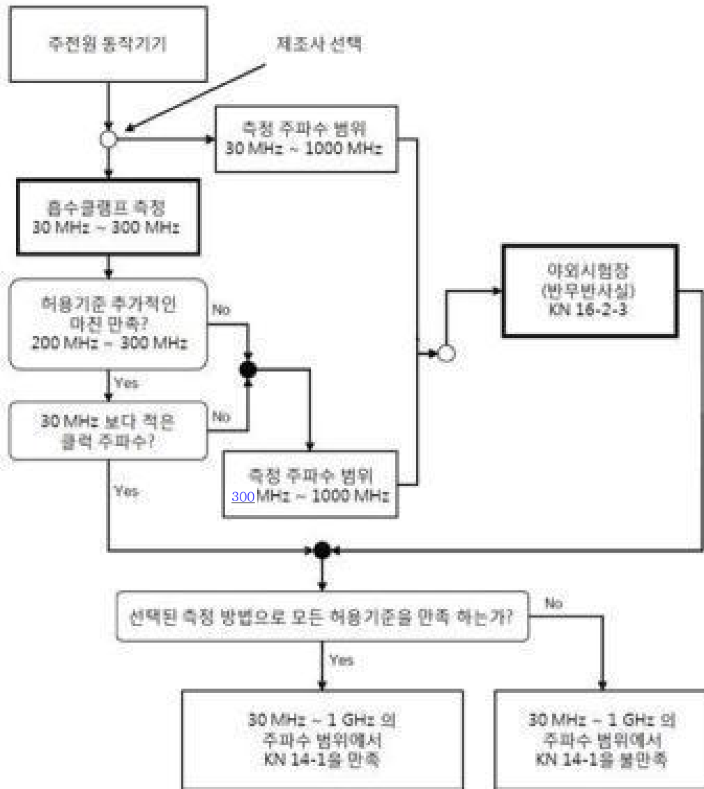
그림 10. 30 MHz ~ 1 000 MHz 주파수 대역에서의 주전원으로 동작되는 기기의 방출 시험 순서도
