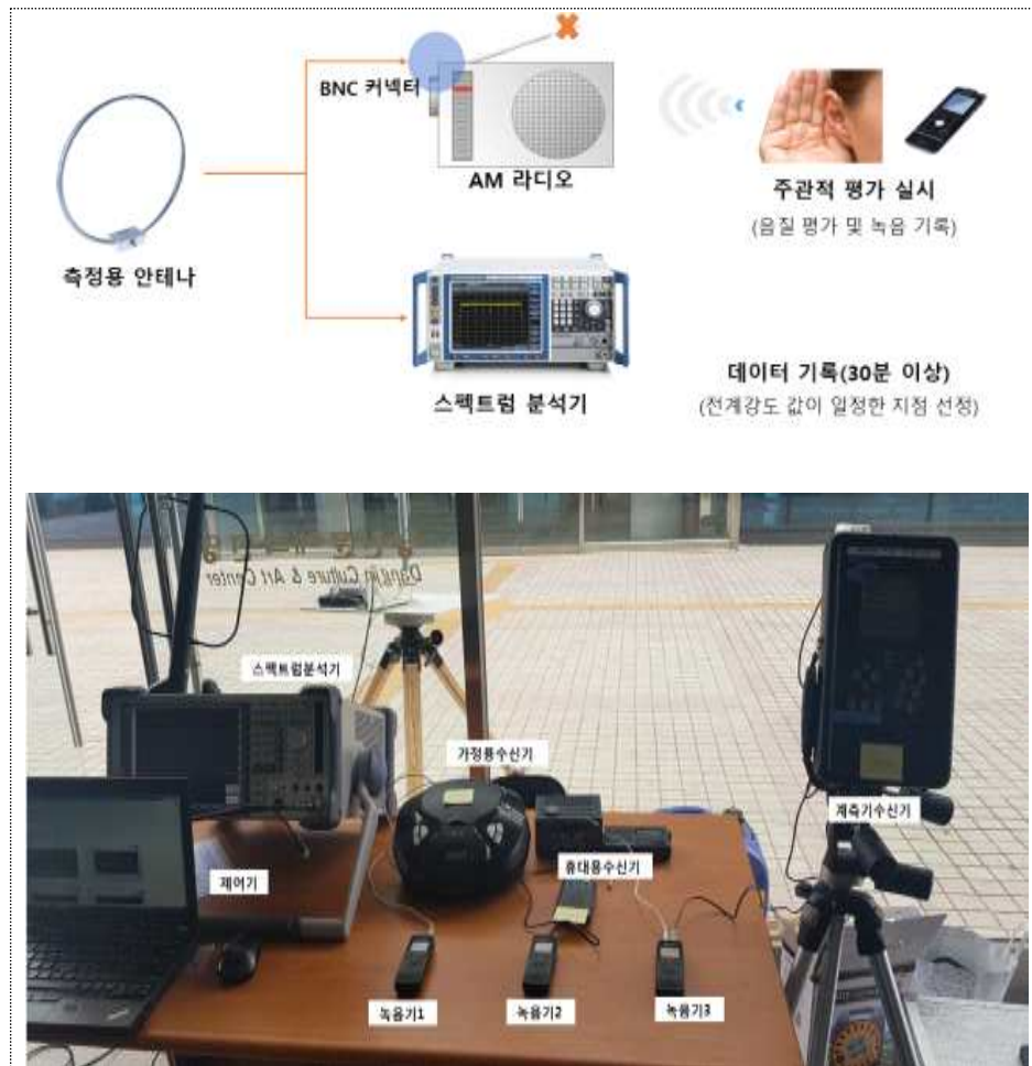
[그림 13] 국내 필드테스트 세부 측정 구성도
