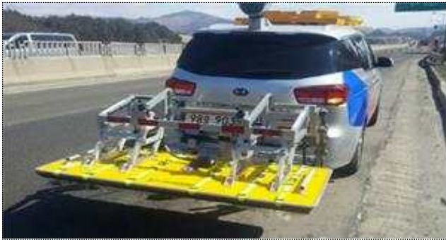
[그림 2-5] 지표면이격방식(Air-Coupled) GPR
