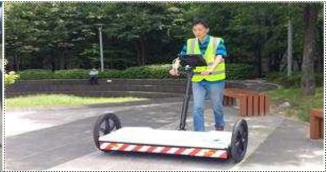
[그림 2-6] 지표면접촉방식(Ground-Coupled) GPR
