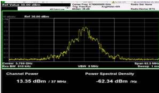
[그림 3-5] 기본 점유주파수대역폭(37MHz)에서의 채널 파워
