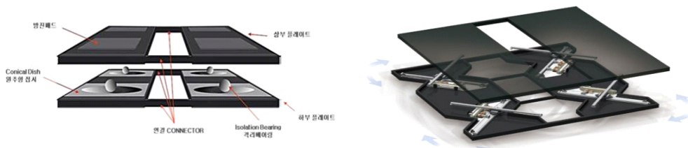
[그림 2-2] 볼타입 면진장치와 LM가이드형 면진장치
