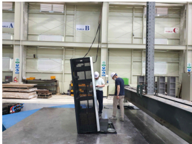
[그림 2-4] 면진장치 포함된 시스템 이탈 상태
