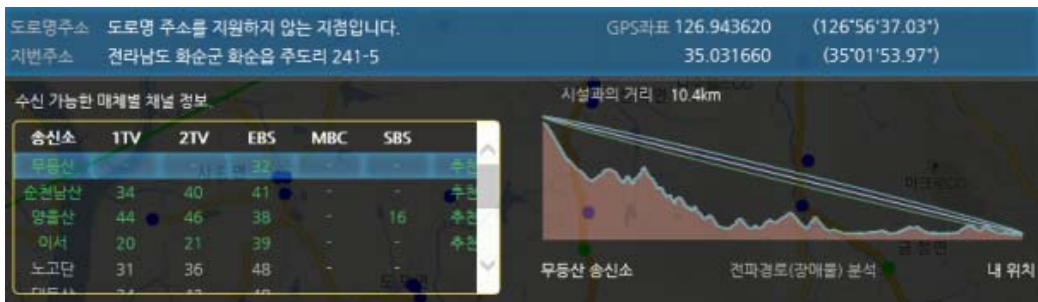
[그림 2-8] 스펙트럼 및 영상 수신여부 측정결과
