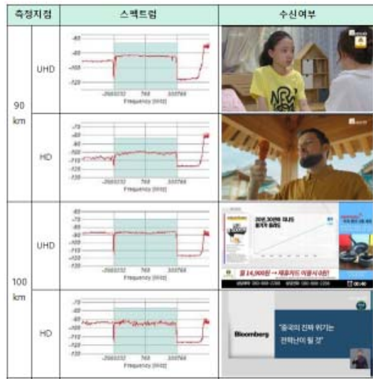
[그림 2-8] 스펙트럼 및 영상 수신여부 측정결과
