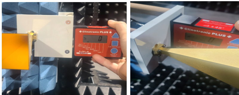
(c) 탐침용 안테나 장착 후 측정장치 수평조정
