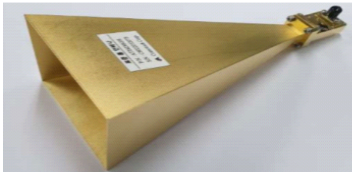
[그림 2.2.8] 제작된 혼 안테나 사진
