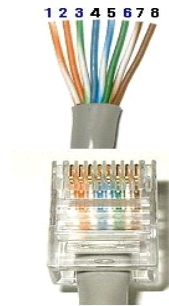
<UTP 케이블 및 접속단자 구성> <UTP 케이블 및 접속단자 형태>
