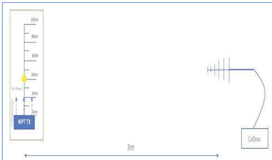
[그림 3-1] 무선전력전송기와 이동통신 간의 간섭영향 실험 구성도
