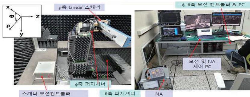
[그림 2.2.5] 평탄도 측정장치 및 측정장비
