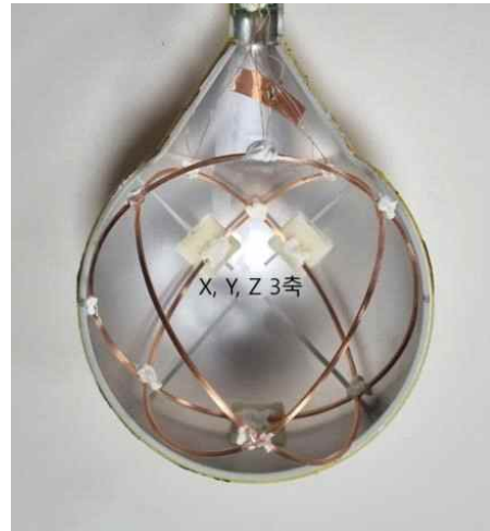
[그림 1-1] 국제표준에 적합한 측정프로브 예시
