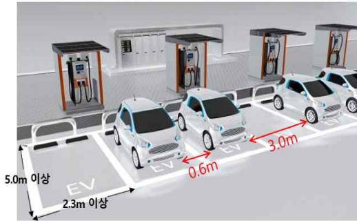
[그림 5-4] 인접 차량의 유·무에 따른 전자파 측정의 필요성
