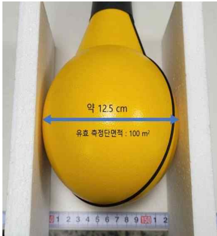
[그림 1-1] 국제표준에 적합한 측정프로브 예시
