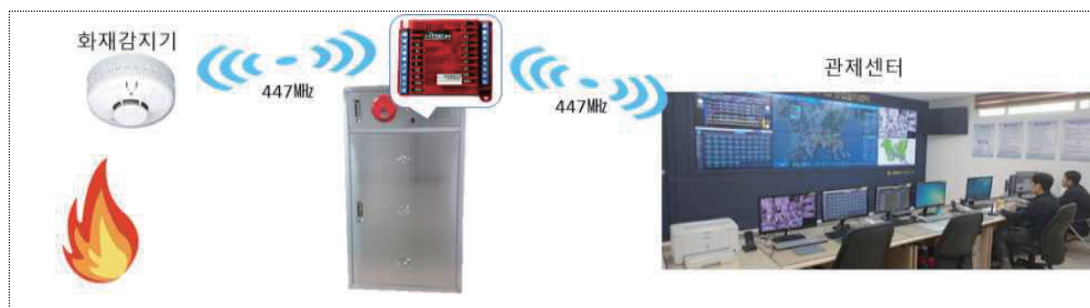
[그림 3] 무선방식 화재경보장치 운용 개념도
