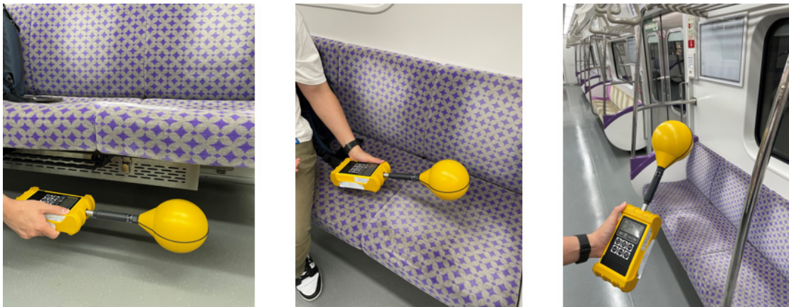
[그림 1] 지하철 바닥-좌석-좌석앞 1.5 m 높이에서의 전자파 측정
