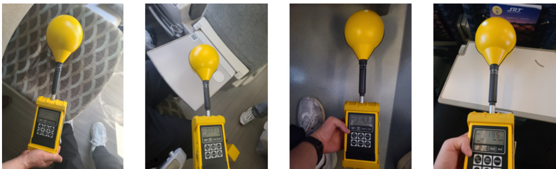
[그림 2] KTX 및 SRT의 객실내 전자파 측정
