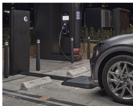
[그림 3-1] 현대자동차 무선충전 시스템 운용 예시
