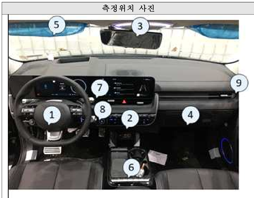
[그림 3-35] 전기자동차 A 전자파 측정(전기장치)
