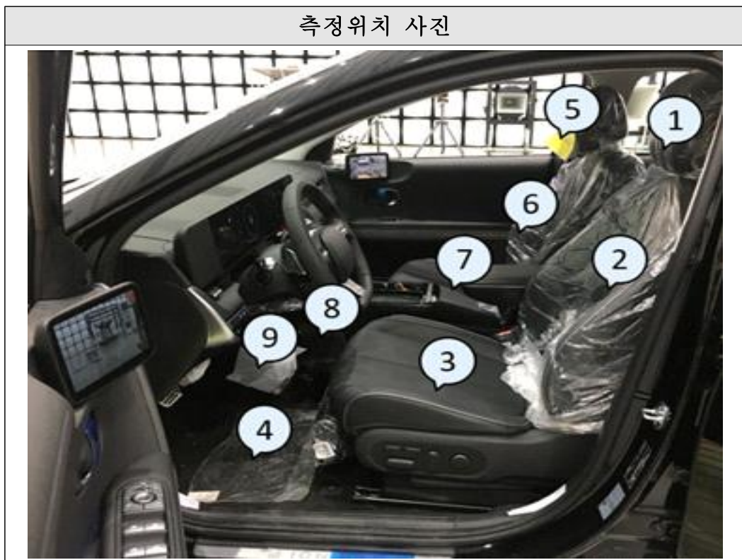
[그림 3-36] 전기자동차 A 전자파 측정(1열시트)
