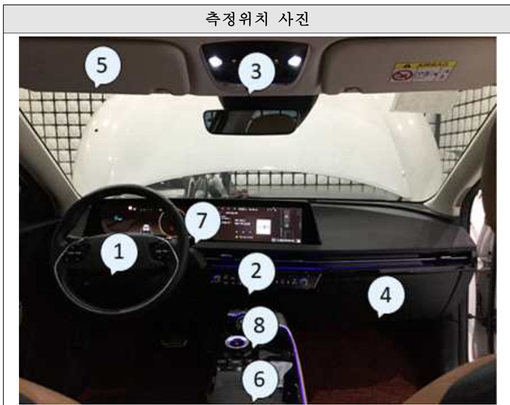
[그림 3-40] 전기자동차 B 전자파 측정(전기장치)
