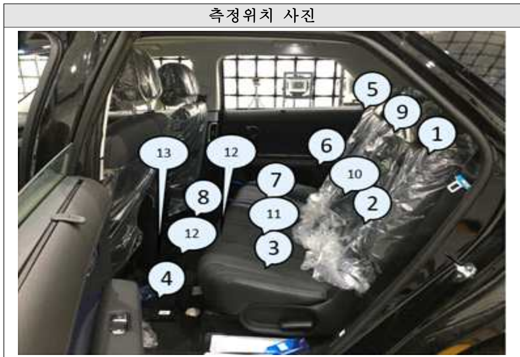
[그림 3-37] 전기자동차 A 전자파 측정(2열시트)
