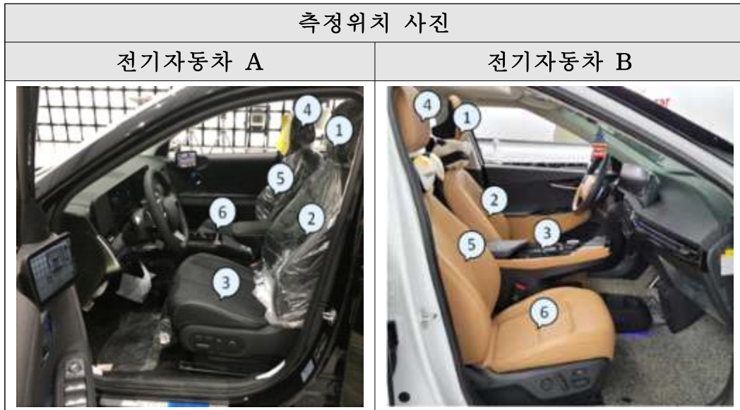
[그림 3-49] 전기자동차 유선 충전설비(급속) A 전자파 측정(내부)
