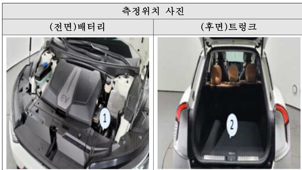
[그림 3-43] 전기자동차 B 전자파 측정(배터리, 트렁크)
