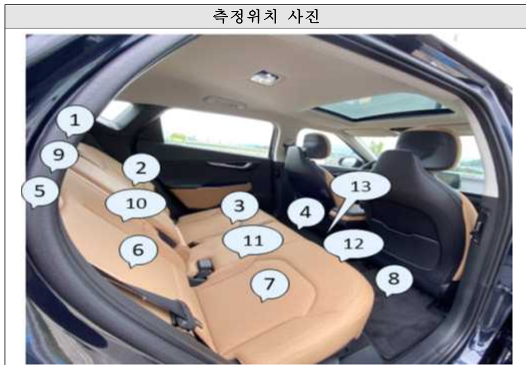
[그림 3-42] 전기자동차 B 전자파 측정(2열시트)
