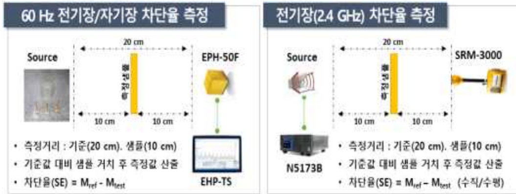
[그림 5-3] 전기장 및 자기장 측정방법
