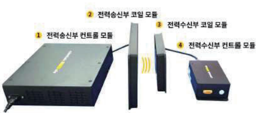
그림 14. 로봇용 전파에너지전송기기의 구성
