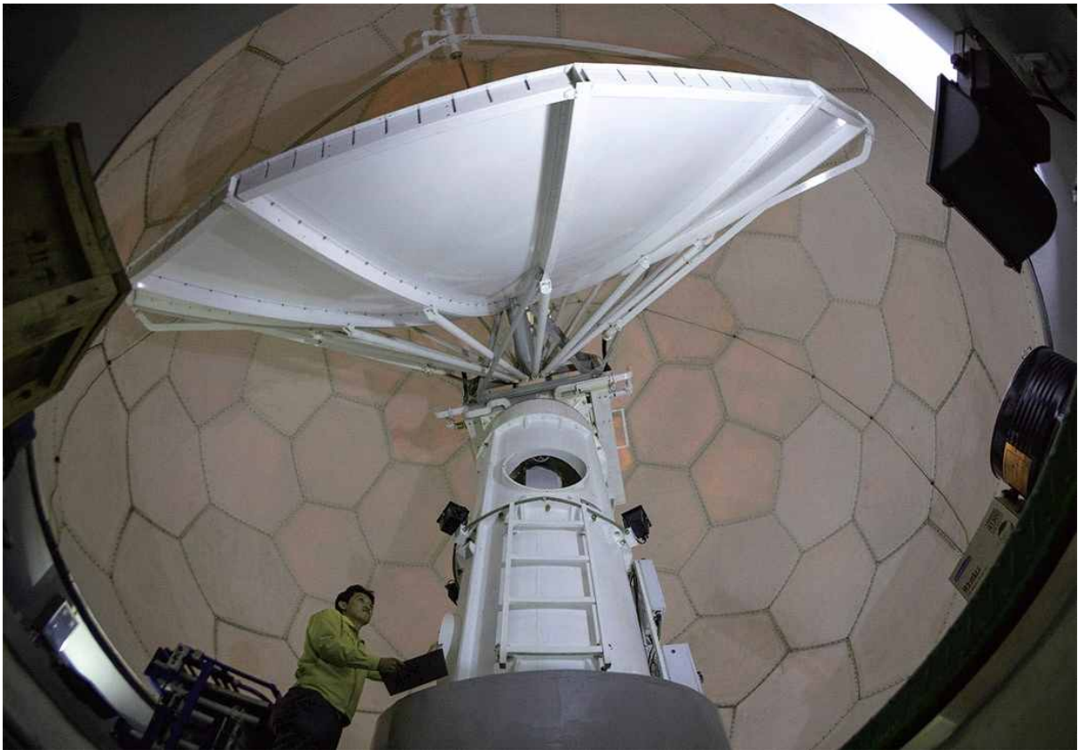
그림 10. S-Band 강우레이다 (소백산 강우레이다(환경부))
