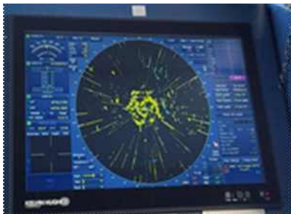
그림 36. No.1 레이다(CH24), No.2 레이다(CH20) 운용 시 전파간섭
