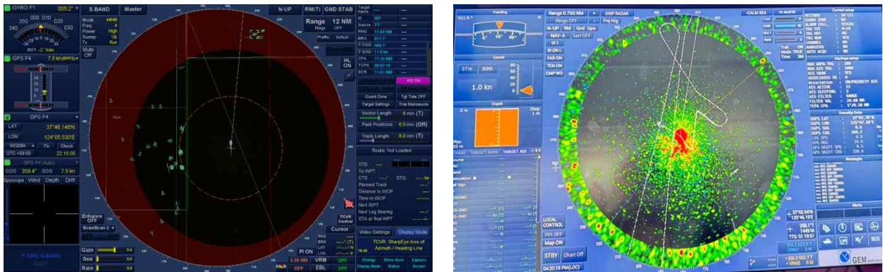
그림 34. SSPA 레이다 운용 중 관측된 장애현상 (출처: 해양경찰청)
