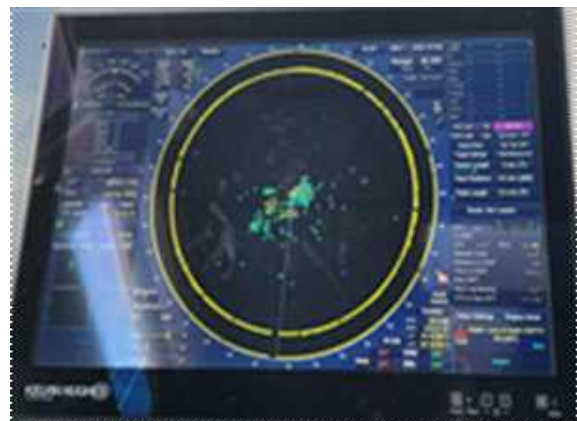
그림 36. No.1 레이다(CH24), No.2 레이다(CH20) 운용 시 전파간섭
