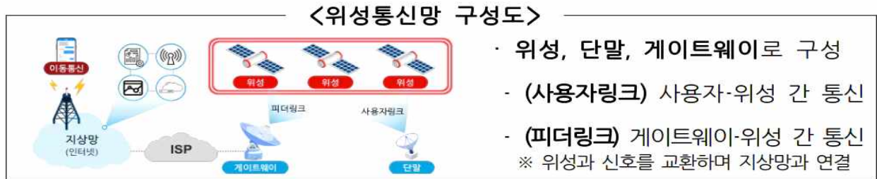
그림 2. 위성 통신망 구성도 예시(출처: 머니투데이 전자신문)
