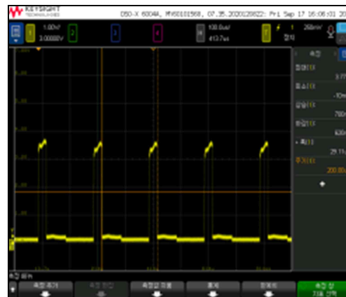
그림 6 펄스 신호 측정 결과 오실로스코프 측정 결과, 펄스폭30μs, 상승시간 700ns, 하강시간 620ns, PRF 200μs로 확인
