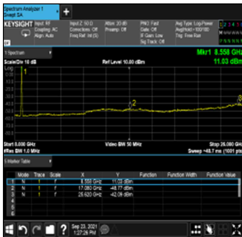
그림 5 스푸리어스 발사 측정 결과 2차 고조파(17.055~17.105GHz) 및 3차 고조파(25.595~25.646GHz) 구간 모두 Noise Level 이하임을 확인
