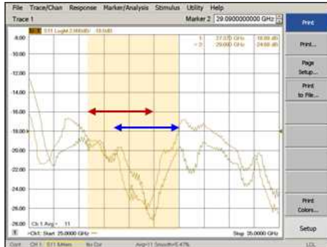
그림 3-38. 28GHz 대역 인체조직 등가용액 접촉유무에 따른 임피던스 변화
