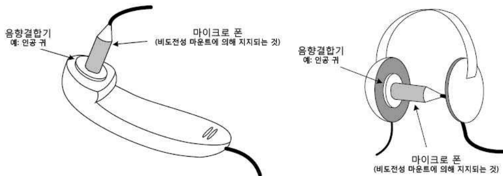
그림 G3. 오프이어 음향 측정을 위한 시험장비구성의 예
