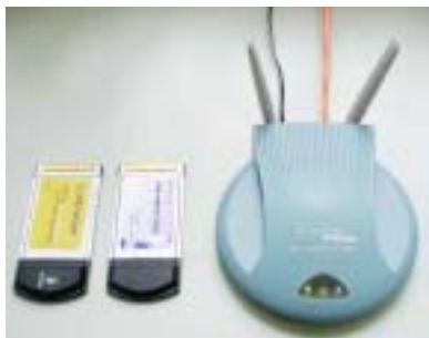
<그림 4-6> 5GHz 대역 주파수 이용 무선 랜 AP 및 NIC 그림
