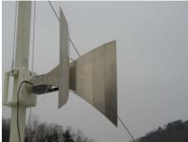
그림 6-6 야외시험장에 설치된 TEM 혼 안테나
