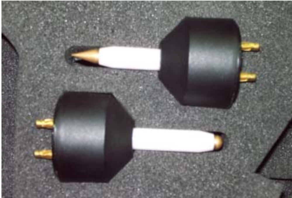
그림 11. PESD-1600 장비의 정전기 발생 팁의 그림. 위쪽의 뾰족한 것이 접촉 방전용이며 아래의 것이 기중 방전용이다.
