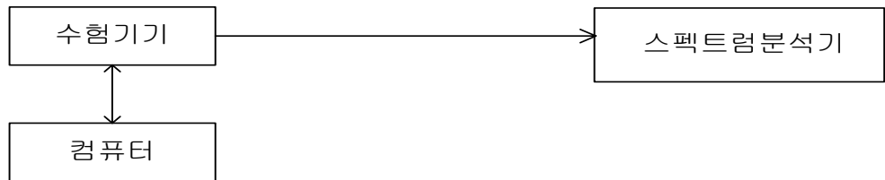
그림 3-2 전력밀도( 허용편차) 시험 구성도
