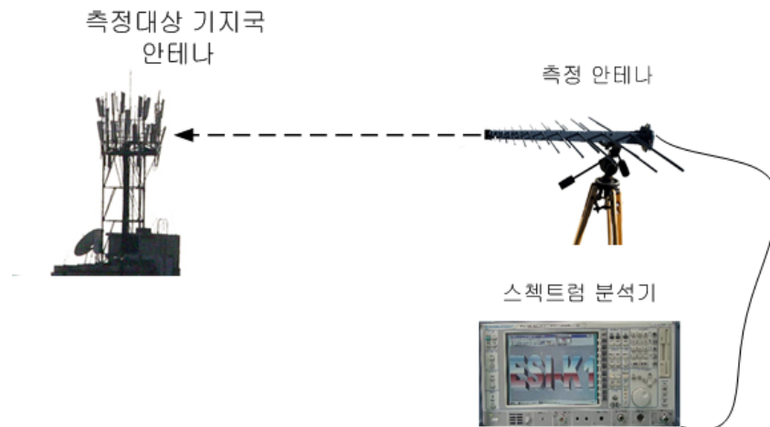
그림 3-2. 이동통신기지국의 전자기장 측정 구성
