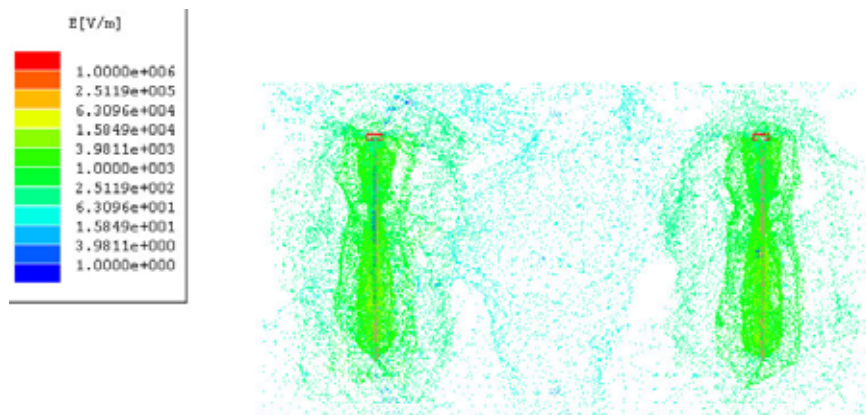
그림 5-14-2 이격거리 70 mm의 수직배열 전계용 프로브의 필드 분포
