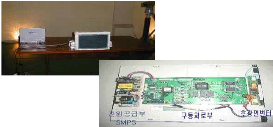
그림 45. 단품 측정과정 및 뒷면 회로 구성
