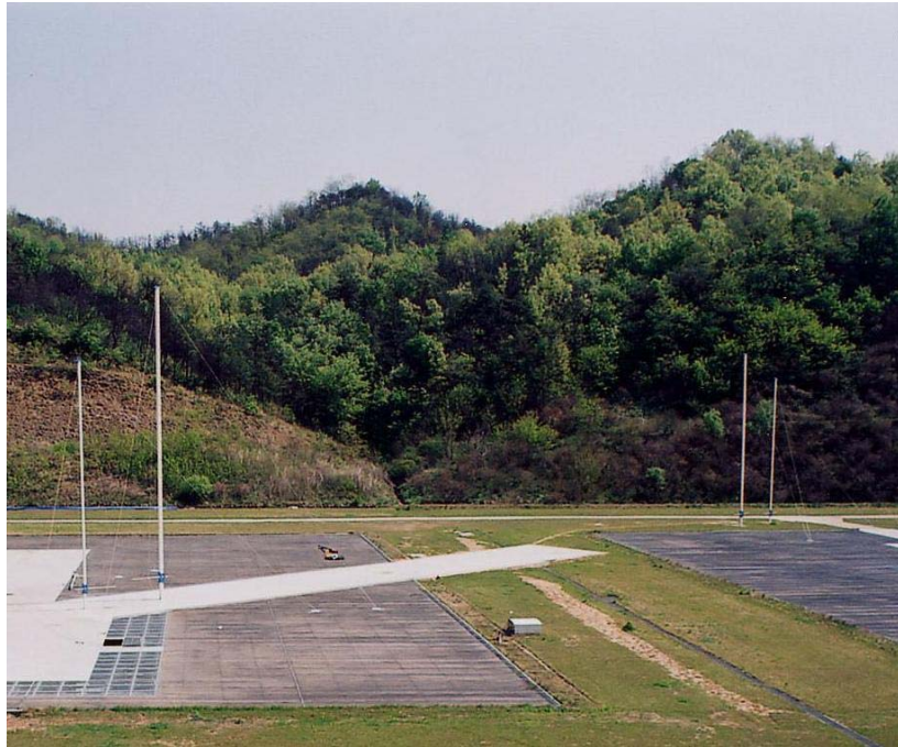
그림 19 표준전계측정 준자유공간법 측정용 시험장 (마스터간 거리 : 60 m, 마스터 높이 : 17 m)
