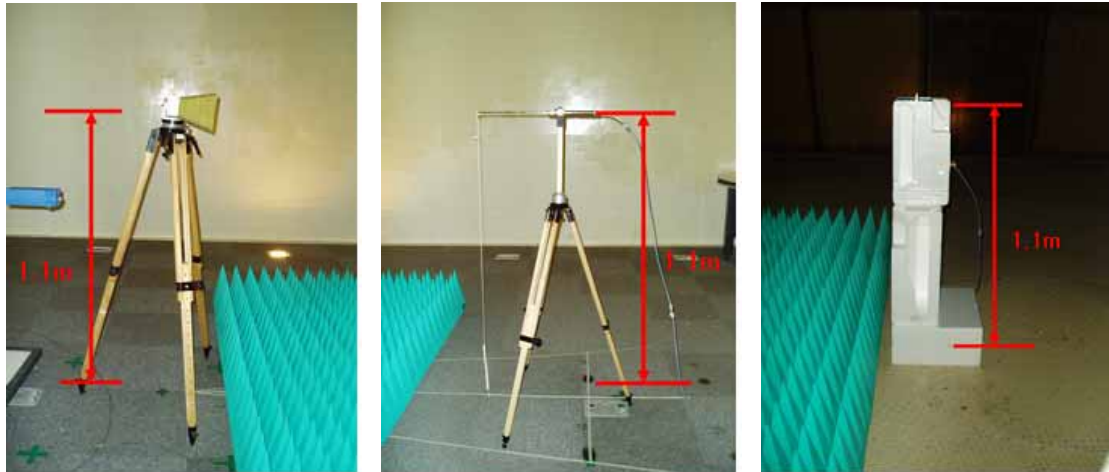
(1) 수신 안테나 (2) SBA 9112 송신 안테나 (3) 우리소 제작 송신 안테나 그림 2-12. 이천 EMI 시험장 평가에 사용된 송·수신 안테나
