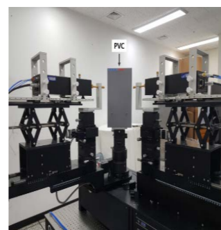
테라헤르츠대역 재질별 전파특성 측정시스템
