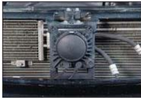
<그림 2-13> Benz 사의 차량용 레이더
