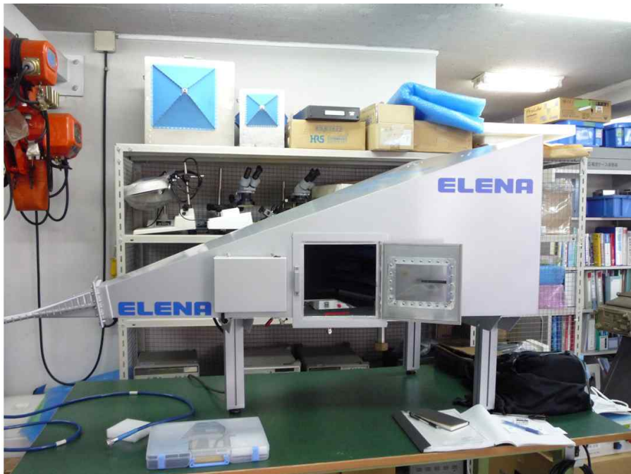
그림 34. GTEM cell을 이용한 차폐율 측정치구
