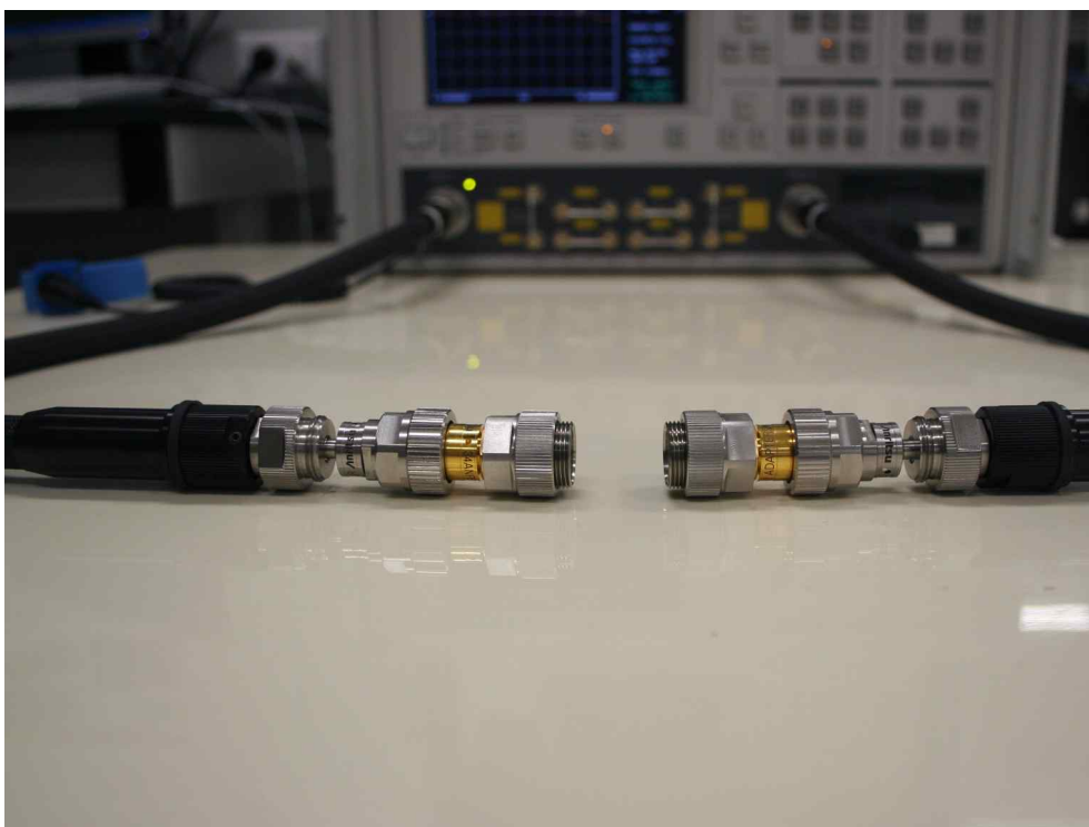
그림 44. 7mm커넥터와 N type to SMA type transition의 조립
