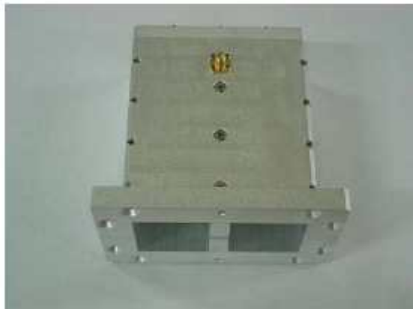
그림 30. 실제 제작 된 1-3.5GHz 차폐효과 측정치구
