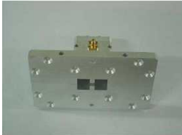
그림 31. 실제 제작 된 3.5-10GHz차폐효과 측정치구
