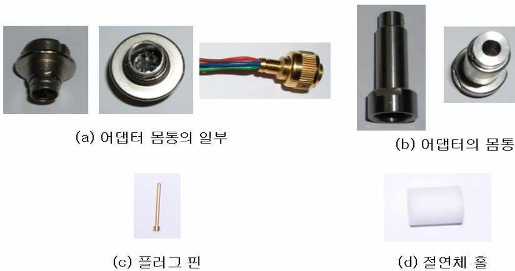
그림 6-9. 제작된 표준 어댑터(A사 SAR 측정시스템에 B사 프로브를 적용)
