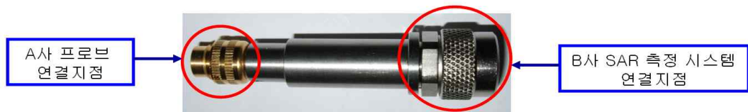
그림 6-12. 표준 어댑터의 완성품 모습(B사 SAR 측정 시스템에 A사 프로브를 적용)
