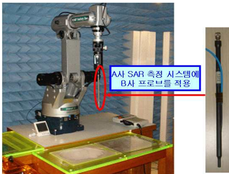
그림 6-13. A사 SAR 측정 시스템에 B사 프로브를 적용한 모습
