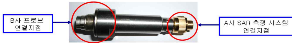
그림 6-10. 표준 어댑터의 완성품 모습(A사 SAR 측정시스템에 B사 프로브를 적용)
