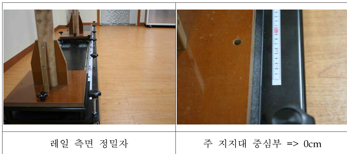
[그림 23] 레일 조립후 지지대 장착 및 수평조절 거리측정용 눈금자
