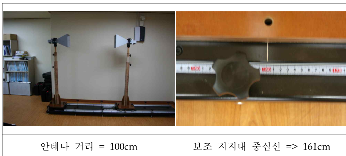
[그림 24] 혼안테나의 개구면 일치 및 높이 조절과 거리 측정
