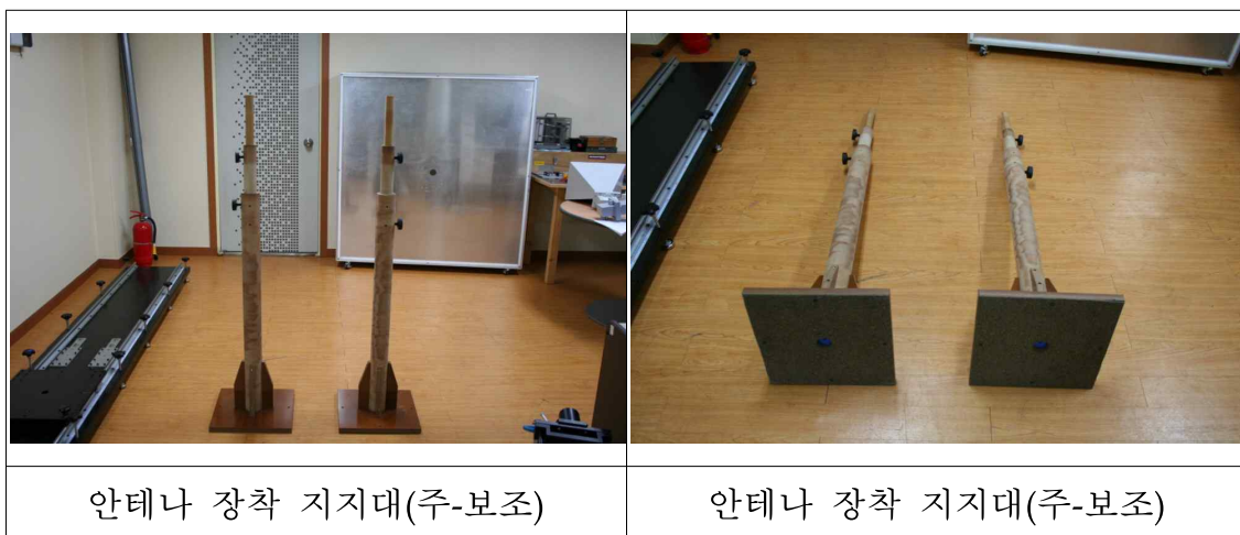
[그림 20] 3단봉으로 구성된 안테나 장착 지지대
