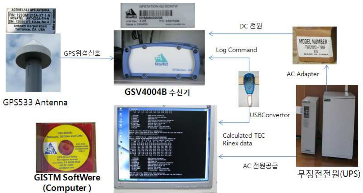
[그림 18] 제주 관측소 시스템 계통도
