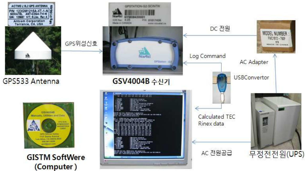
[그림 16] 이천 관측소 시스템 계통도
