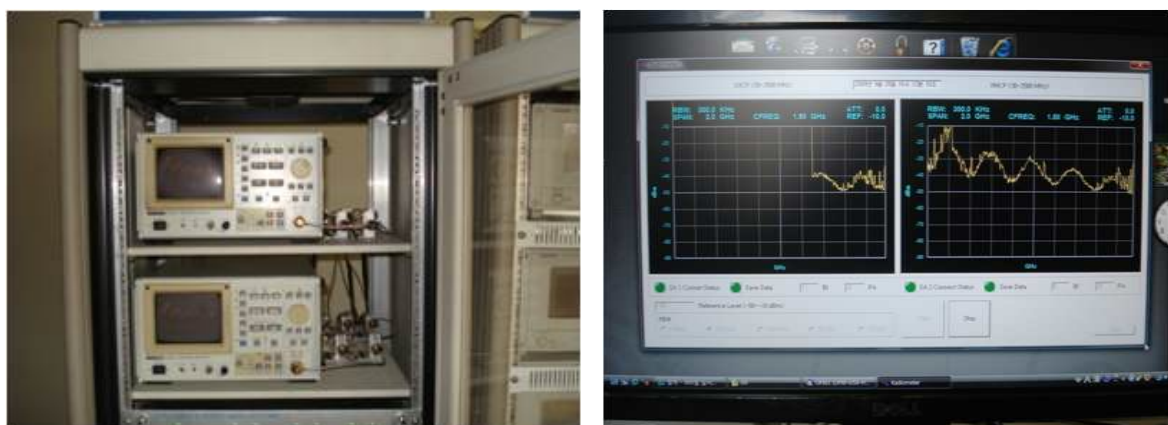
[그림 35] 태양전파 주파수 분석시스템 제어부
