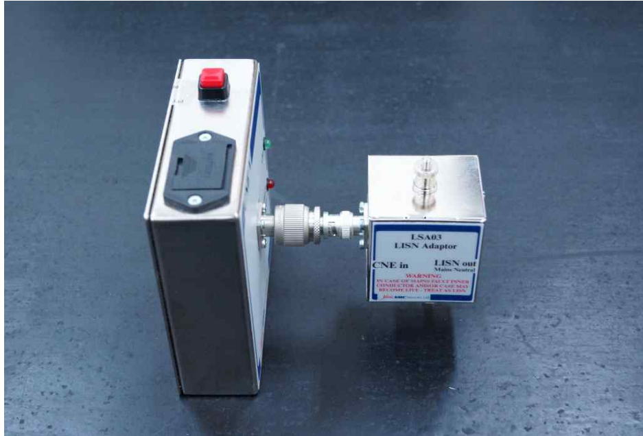
[그림 5] Conducted Test Jig 장착 상태
